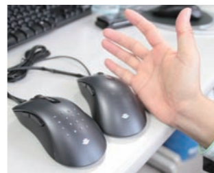
【触覚マウス】 マウスの手のひらが当たる部分に複数の突起。これが擬似的な触覚を生み出します。
